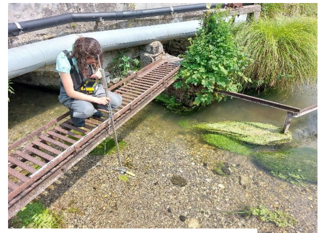
Mesures de débit réalisées dans le cadre d'un stage sur les cressonnières
